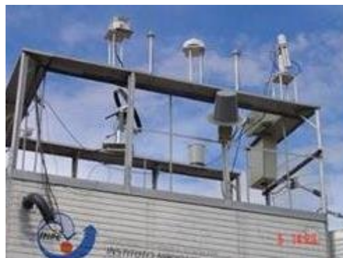
Fig. 3 - Estação solarimétrica do projeto SONDA, composta por: piranômetro, sensor PAR, pirgeômetro, luxímetro, fotômetro / sistema aeronet, sombreador, etc.
