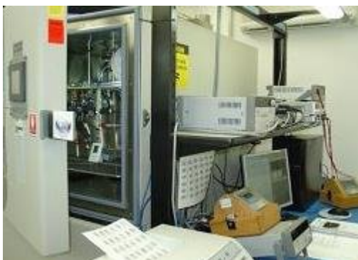
Fig. 6 - Sistema de calibração de temperatura e umidade.
