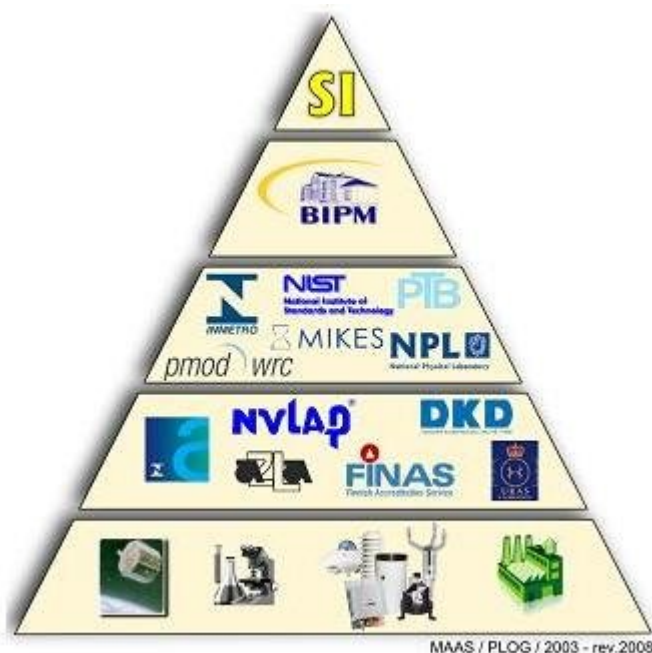
Fig. 1 - Diagrama de rastreabilidade metrológica
