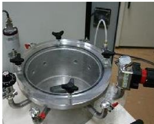
Fig. 8 - Sistema de calibração de barômetros.
